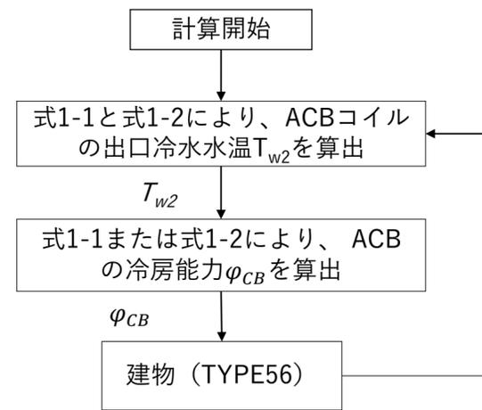
If  $T_{room} > \text{設定温度}$ , then 冷水流量  $q_w > 0$  [kg/s]
