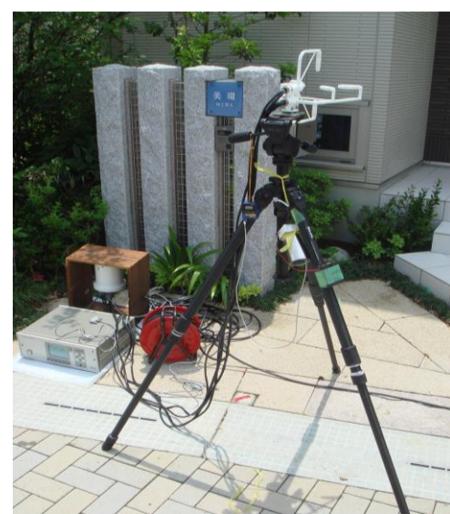
超音波風速計 + 通風管 + 温湿度計
