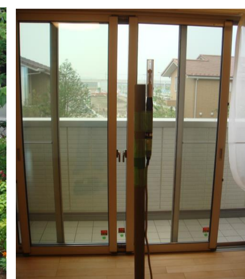
携帯型風速計 + 通風管 + 温湿度計
