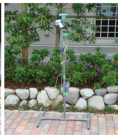
携帯型風速計 + 通風管 + 温湿度計
