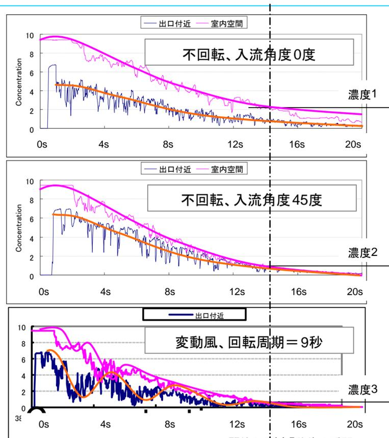
図9 汚染物の稀釈速度 開始から14.5秒後の瞬間
