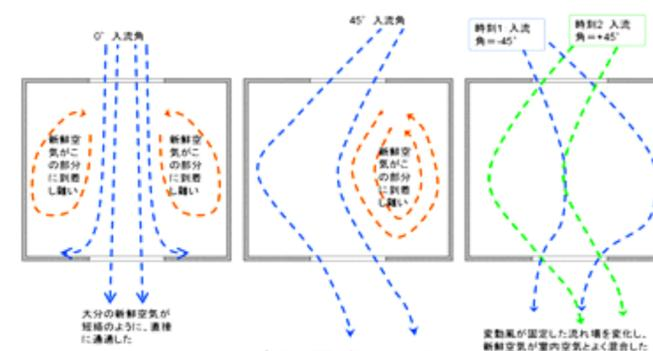
図10 変動風換気の略図
