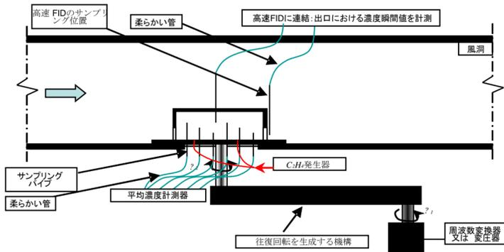
図8 変動風風洞実験
